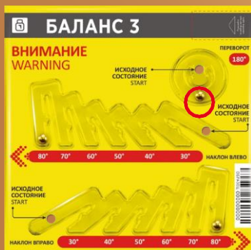
Индикатор в сработавшем состоянии при повороте на 180°
