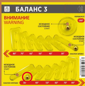
Индикатор в сработавшем состоянии при повороте на 30° вправо
